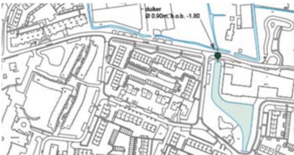
Figuur 2.5.9: De te vergroten duiker aan het Zakendijkje nabij de Lucebertschool
