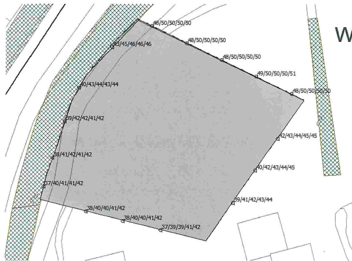
Figuur 4.6: gecumuleerde geluidsbelasting noordwestelijk blok
