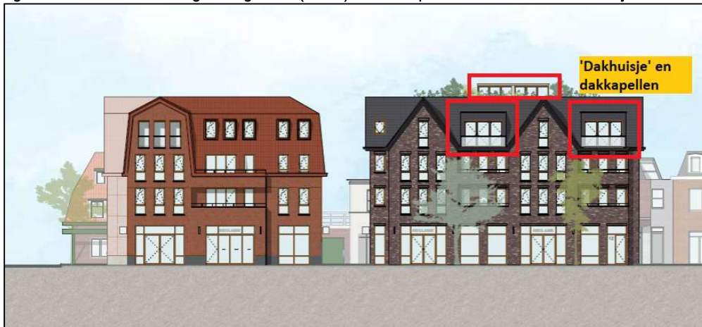
Figuur 2. Gevelaanzicht voorgevel L-gebouw (rechts) met daarop in het rode kader het 'dakhuisje' en de dakkapellen
