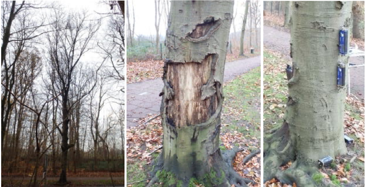
Foto beuk 1, Eeuwigelaan te Bergen. Rechts de gebruikte sensoren op de stamvoet en stam aan westzijde.
