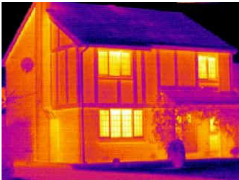
Een thermografische foto van een woning. De rode vlakken geven de warmte aan die uit de woning lekt.
